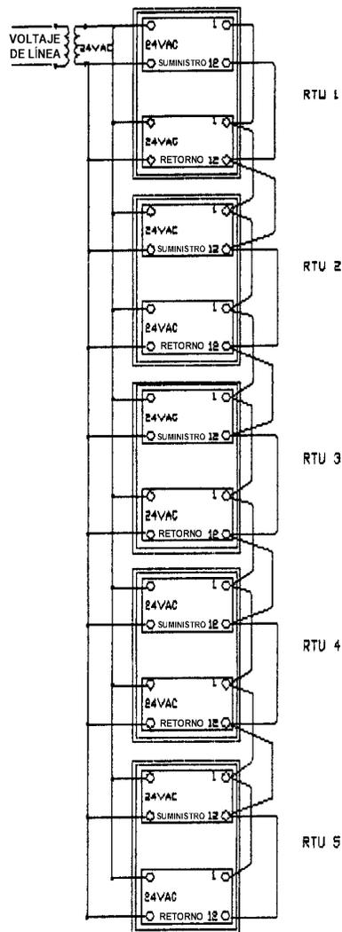
Si usted tiene más de 5 unidades HVAC, usted puede conectar juntos todos los suministros en un solo suministro de energía (hasta 10 unidades HVAC) y juntos todos los de retorno (hasta 10 unidades HVAC) en otro suministro de energía. Vea el siguiente ejemplo de cableado en campo.
