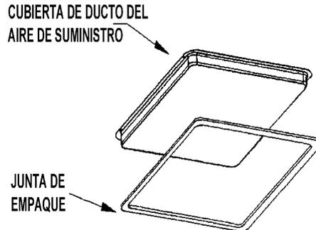
3. Coloque en posición las cubiertas del ducto según se muestra más abajo. La cubierta del ducto de suministro se instala (aislamiento cara-abajo) sobre la abertura de retorno hacia abajo, engancho un lado del panel debajo del ángulo de retención y asegurando el otro lado con 3 tornillos.
